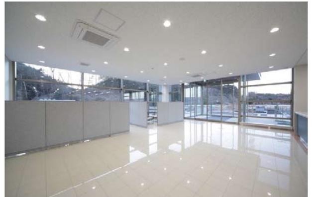
東北自動車道矢板インターチェンジから0.5km、栃木県矢板南産業団地内に新設した通過型の物流センター（TC：トランスファーセンター）である。環境への配慮として、トップライトの採用、照明の調光制御、LED照明の採用等を行った。拡散板を用いたトップライトは太陽光を均斉度の高い昼光照明とみなすことを可能とし、業務時間のおよそ70%の時間は照明を消灯し自然採光で必要照度を確保することを目指す。また、土間コンクリートのひび割れ防止対策、避難安全検証法を用いた安全確保とローコスト化の両立を図っている。
