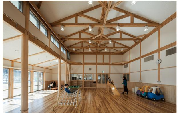
本プロジェクトは実施設計プロポーザルにおいて、屋根架構のみを木造とする当初の基本設計に対し、全ての柱・梁などの構造部材に地元産の木材を使用する点、町民のふれあいを創出する分棟配置、自然エネルギー利用などの環境配慮への取り組み提案が評価され選定された。
