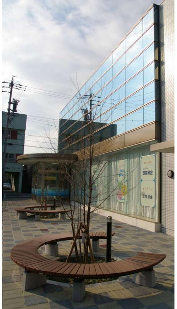
建物正面にゆとりをもたせ、ポケットパークとして緑地やベンチを配置するなど、利用者と地域へ開放している。身障者が利用可能な多目的便所の設置、ポケットパークに歩行感の良いゴムチップ層を持つリサイクル保水性舗装の採用、基礎躯体にラス型枠の採用、駐車場舗装に透水性アスファルト舗装の採用など、小規模ながらも利用者と環境にやさしい施設としている。
